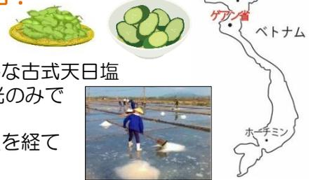
入浜式塩田：塩田に撒いた砂を毛細管現象によって結晶化させ、これを集めて海水をかけて濃縮させます。濃縮海水を作ります。
